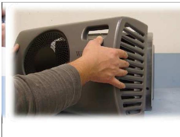
Отвернуть 2 винта, расположенные с двух сторон кондиционера Winemaster
