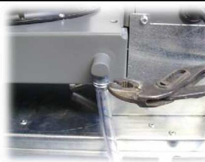
Затянуть кольцо с помощью универсального гаечного ключа или плоскогубцев.
